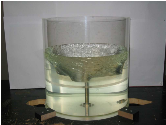
Delvist fyldt cylinder med roterende bundplade
